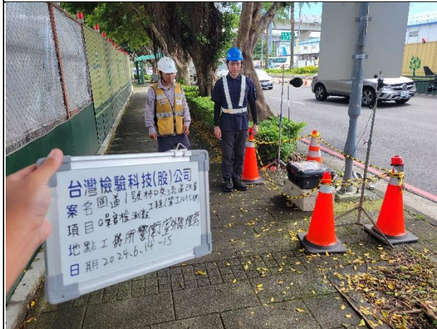
監測項目：環境噪音振動 監測日期：2024.06.14~15 監測地點：工務所警衛室外路燈旁
